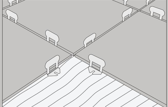
LEGEN SIE FLIESEN UND LEGEN SIE CLIPS EIN. (SIEHE KONSUMTIONSTABELLE FÜR EMPFOHLENE ANZAHL VON CLIPS) PLACE TILES AND INSERT CLIPS. (SEE CONSUMPTION TABLE FOR RECOMMENDED AMOUNT OF CLIPS)
